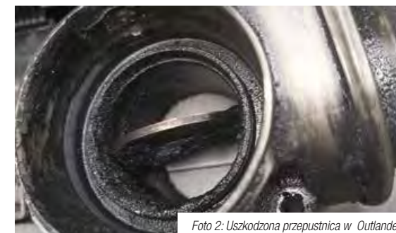
Foto 2: Uszkodzona przepustnica w Outlanderze
