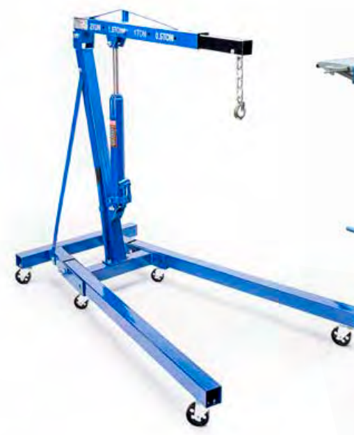
Ilustracja 5 | Żuraw do wyciągania silników o nośności maksymalnej 2 ton. – HST 290 Źródło: Inter Parts
