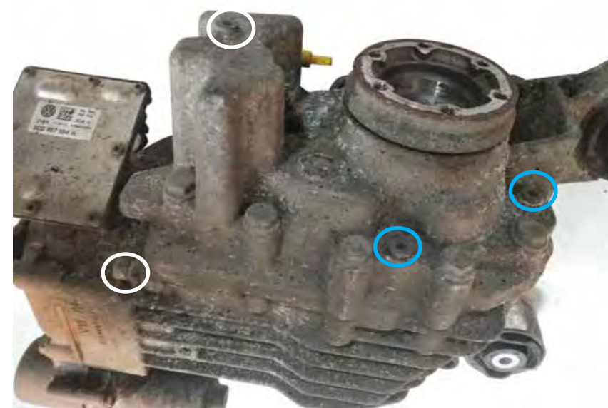
Rys.2 | Rozmieszczenie poszczególnych korków spustowych i wlewowych oleju w sprzęgłe Haldex (oznaczenie białe) i części mechanizmu różnicowego (oznaczenie niebieskie) w układzie Haldex V generacji
