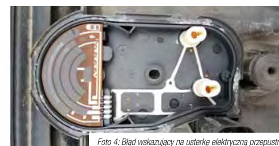
Foto 4: Błąd wskazujący na usterkę elektryczną przepustnicy
